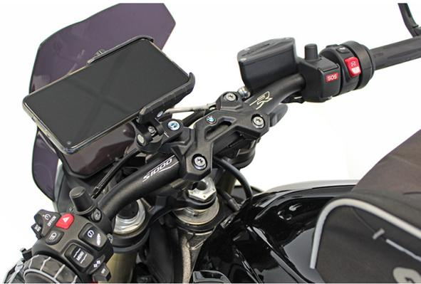
Mit dieser Smartphone-Halterung (Artikel 92248) haben Sie Ihr Mobiltelefon immer griffbereit und gut sichtbar auf dem Motorrad dabei. Die Halterung ist kompakt gebaut und lässt sich schnell an der Lenkerklemmung oder der Griffarmatur befestigen und entfernen.
