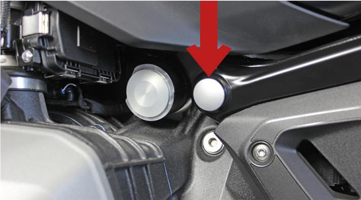
Diese Abdeckungen für das offene Rohr der Motorbefestigung sind aus robustem Aluminium hergestellt und silber bzw. schwarz eloxiert. Die 2 Rahmenabdeckungen werden seitlich hinter dem Zylinder, links und rechts, angebracht. Wird auch als Deckel / Abdeckung / Abdeckstopfen / Abdeckkappe / Rahmenstopfen bezeichnet. Die Rahmenabdeckungen werden jeweils im Set (2 Stück) geliefert.
