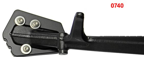
Mit dieser Seitenständervergrößerung ist auf allen Untergründen ein sicherer Stand Ihrer Maschine gewährleistet, da die Auflagefläche um mehr als 100% erhöht wird. Die Vergrößerung ist aus hochwertigem Aluminium gefertigt, schwarz eloxiert und enorm leicht zu montieren.
