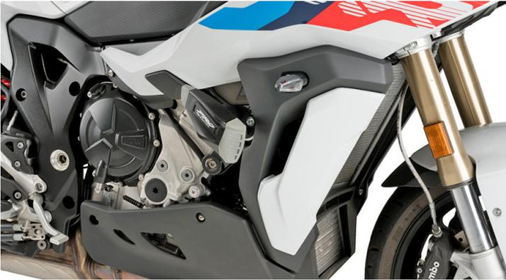
Durch die Crash- oder Sturzpads erhalten Sie zusätzlichen Schutz, um Schäden am Motor und am Rahmen zu vermeiden.
