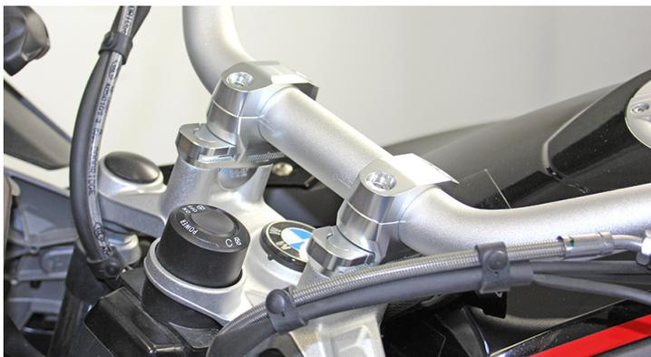
Lenkererhöhung mit Versatz: 30mm höher & 14mm vor- bzw. zurückversetzt
