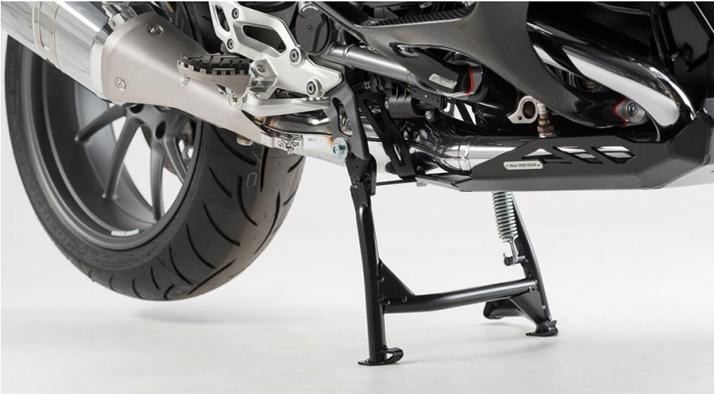
Dieser Hauptständer zeichnet sich durch sehr gute Passgenauigkeit, Stabilität sowie ausgezeichnete Standfestigkeit aus. Eine unersetzliche Hilfe für alle Arbeiten am Motorrad wie Bremsscheibenbeläge wechseln, Öl nachfüllen, etc.
