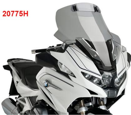
Die Variotourenscheibe ist ein Windschild, das am Ende des Windabweisers eine Art Spoiler hat, der sich manuell im Winkel verstellen lässt. Durch die Hinterströmung des Spoilers werden gleichzeitig die sonst so lästigen Turbulenzen reduziert.
