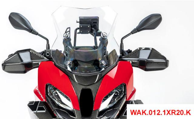
Der Windabweiser am Cockpit in Carbon für die BMW S1000XR (2020- ) & M1000XR ersetzt das originale Bauteil unter Verwendung der originalen Befestigungspunkte.
