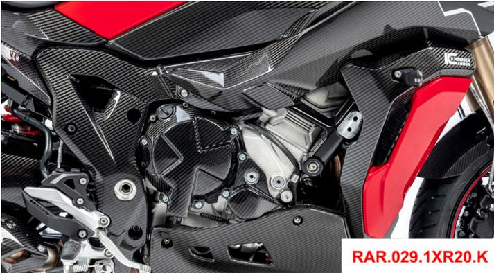
Diese Rahmenschützer sind aus hochwertigem Carbon hergestellt und mit UV-beständigem Klarlack beschichtet. Die Rahmenabdeckungen in Carbon für die BMW S1000XR (2020- ) & M1000XR werden mit Hilfe der bereits am Carbonteil angebrachten Klebestreifen am Rahmen aufgeklebt.
