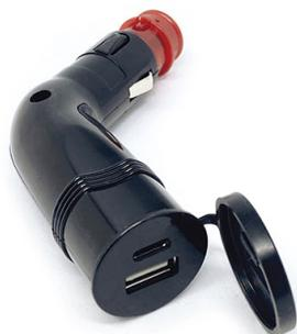
Unser USB-Adapter für Motorradsteckdosen (USB10) dient der Adaptierung von verschiedenen Bordsteckdosen 12/24V auf den USB-Standard 5V auf 2 USB-Buchsen (USB-A und USB-C mit jeweils max. 3,6A). Als Besonderheit passt er nicht wie herkömmliche Adapter nur in Zigarettenanzündersteckdosen, sondern durch Abnahme (Bajonettverschluss) der roten Kappe auch in DIN-Steckdosen (Artikel-Nr.: 90025) oder z.B. die Serien-Bordsteckdosen von BMW Motorrad.
