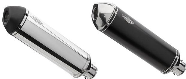
Der SHARK DSX-5 Slip-On-Endtopf überzeugt sowohl mit seinem speziellen Design als auch durch seinen kernigen, kraftvollen Klang. Der elliptische Endtopf mit fünfeckiger Endkappe ist aus poliertem Aluminium bzw. schwarz eloxiertem Aluminium gefertigt und wird mit einem schraubbaren Halter befestigt. Der dB-Absorber des Auspuffs ist entfernbar und der Originalkatalysator bleibt beim Einbau erhalten. Wird auch als Endschalldämpfer bezeichnet.
