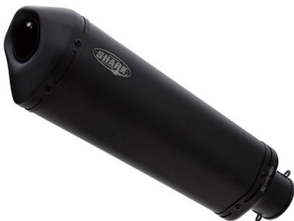
Der SHARK DSX-10 Slip-On-Endtopf überzeugt sowohl mit seiner konisch fünfeckigen Form als auch durch seinen kernig aggressiven Klang und seiner maximalen Leistung. Der Endtopf ist aus beschichtetem Edelstahl gefertigt und wird mit einem schraubbaren Halter befestigt. Der dB-Absorber des Auspuffs ist entfernbar und der Originalkatalysator bleibt beim Einbau erhalten. Wird auch als Endschalldämpfer bezeichnet.
