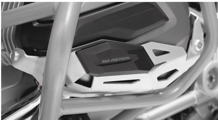
Dieser Zylinderschutz bewahrt Ihre Boxer-Zylinder vor Steinschlägen und Schäden durch Stürze. Die Abdeckungen sind speziell an die Form der Ventildeckel angepasst und sind an ihrer Innenseite mit einer dämpfenden Gummieinlage ausgestattet. Der silberne Grundrahmen besteht aus gelaserten und gebürsteten Aluminium, während das schwarze Pad aus CNC-gefrästem Aluminium gefertigt ist. Wird auch als Zylinderschutz / Ventildeckel- & Zylinderprotektor bezeichnet.
