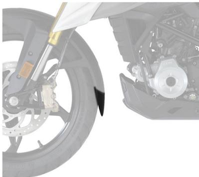
Diese aus ABS-Werkstoff tiefgezogene Verlängerung des originalen Kotflügels macht Schluss mit Problemen wie verdreckte Krümmer, Motorgehäuse, Steinschlagschäden und unnötige Wasseraufwirbelungen. Lieferung komplett mit Befestigungsmaterial (Spreiznieten und doppelseitiges Klebeband) für einen schwingungsfreien und festen Sitz.
