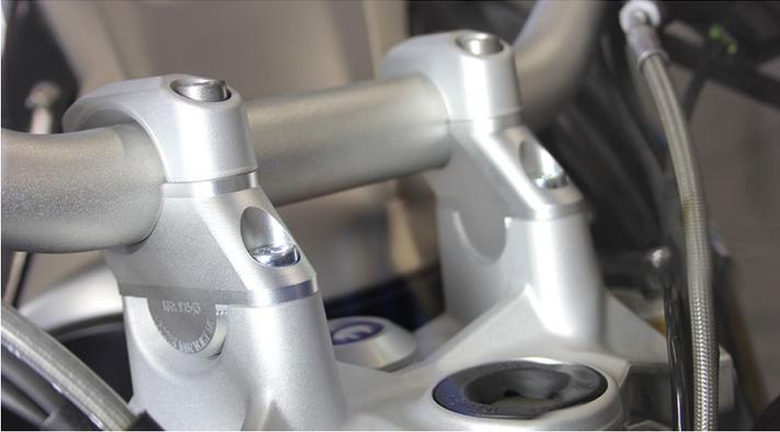
Lenkererhöhung mit Versatz: 30mm höher & 21mm zurückversetzt
