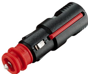
Der Stecker passt mit der roten Kappe in Zigarettensteckdosen (z.B. ZA 01-04), mit abgenommener Kappe (Bajonettverschluss) zu DIN-Bordsteckdosen wie SD14/15 oder z.B. BMW-Serienbordsteckdosen.
