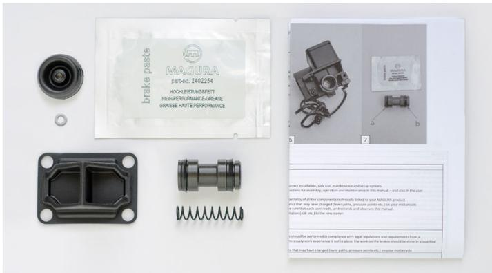
Für alle Motorräder, die mit der hydraulischen 288er-Bremsarmatur von Magura unterwegs sind, bietet Magura ein 20mm Reparatur-Kit an, das alle Teile beinhaltet, um die 288er-Armatur komplett zu überholen. Nach vielen Jahren und Kilometern ist es empfehlenswert den Geberzylinder gründlich zu reinigen und alle Dichtelemente zu erneuern.
