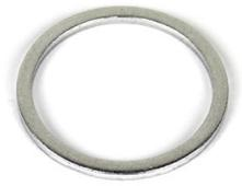
Aludichtung bzw. Aludichtring für Ölablassschraube. Passend für alle BMW R1200 (LC) mit wassergekühltem Motor. Der Aluring hat einen Innendurchmesser von 20mm und einen Aussendurchmesser von 24mm.
