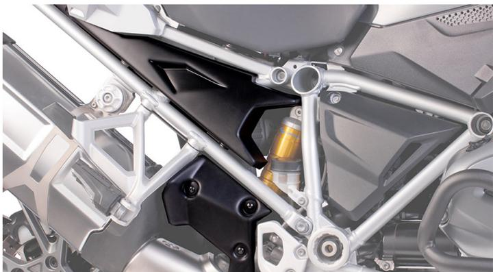
Um die großen Öffnungen des Gitterrohrrahmens Ihrer BMW R1250GS zu schließen, stehen Ihnen diese Seitenverkleidungen (3-teilig) zur Verfügung. Das Spritzwasser vom Hinterrad an Ihren Beinen wird dadurch effektiv minimiert. Die Montage ist einfach. Die Seitenverkleidungen sind in schwarz erhältlich.
