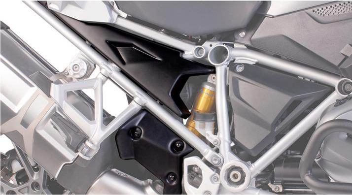
Um die großen Öffnungen des Gitterrohrrahmens Ihrer BMW R1200GS LC zu schließen, stehen Ihnen diese Seitenverkleidungen (3-teilig) zur Verfügung. Das Spritzwasser vom Hinterrad an Ihren Beinen wird dadurch effektiv minimiert. Die Montage ist einfach. Die Seitenverkleidungen sind in schwarz erhältlich.
