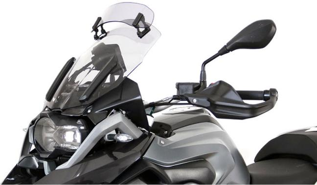
Es handelt sich dabei um eine Tourenscheibe, die am Ende des Windabweisers eine Art Spoiler hat, der sich manuell im Winkel und in der Länge in sieben Positionen verstellen lässt. Durch die Hinterströmung des Spoilers werden gleichzeitig die sonst so lästigen Turbulenzen reduziert.
