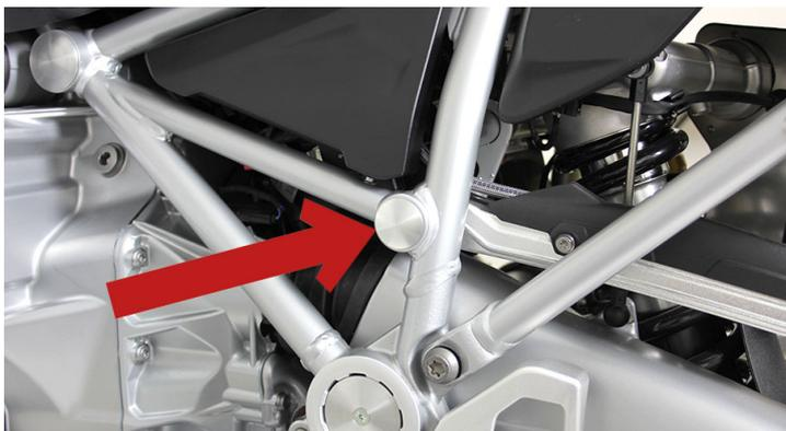
Diese Abdeckung für das offene Rohr über dem Schwingenlager ist aus robustem Aluminium hergestellt und in silber und schwarz eloxiert und in blau oder rot lackiert erhältlich. Wird auch als Deckel / Abdeckung / Abdeckstopfen / Abdeckkappe / Rahmenstopfen bezeichnet. Die Rahmenabdeckung wird an der linken Seite angebracht.
