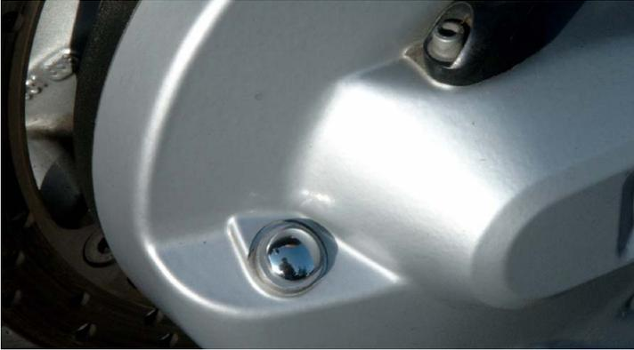
Chromkappe II für die Kardanöleinfüllschrauben
