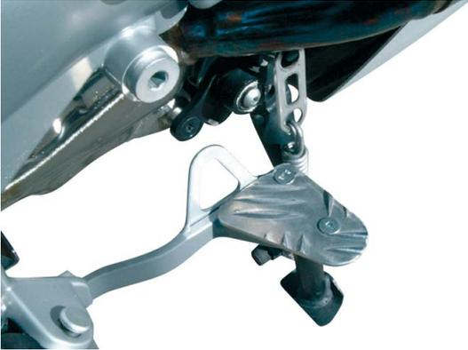
Bremshebelvergrößerung aus Alutränenblech gefertigt. Beim Original ist die Fußauflagefläche etwas zu klein und stellt nicht selten ein Sicherheitsrisiko dar. Ein Tritt ins Leere ist jetzt Vergangenheit. Das Tränenblech ist sehr griffig, verhindert dadurch ein Abrutschen bei Nässe. Befestigung mit zwei Schrauben, zwei Unterlegscheiben, zwei Stopmuttern.
