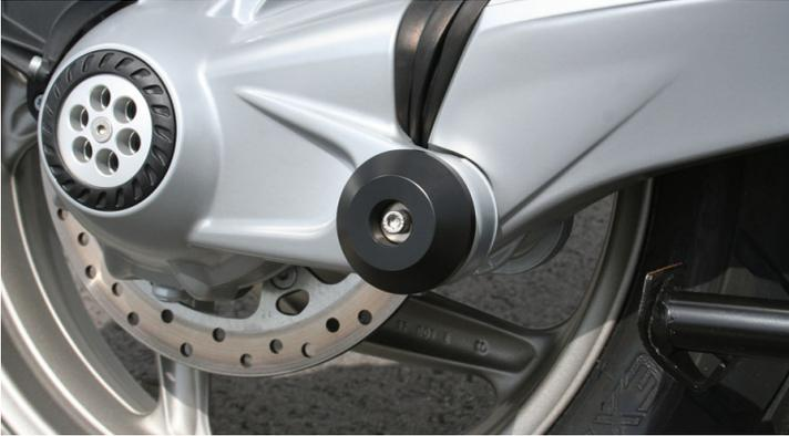
Dieses Crash- oder Sturzpad für den Kardan ist aus CNC gedrehtem Kunststoff hergestellt und sorgt für zusätzlichen Schutz um Schäden an Ihrem Motorrad zu vermeiden. Befestigt wird das Sturzpad am Kardan mit einer Edelstahl-Schraube und einen Expansionshalter.
