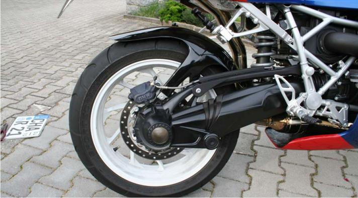
Unsere neue Hinterradabdeckung ist aus qualitativ hochwertiger Glasfaser gefertigt, hält durch ihre Breite und Länge die Beine des Fahrers und des Sozius bzw. der Sozia trocken und schützt zugleich noch das Federbein sowie den kompletten Unterbau Ihrer Maschine.
