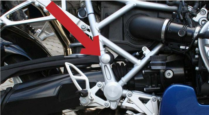
Diese Abdeckung für das offene Rohr über dem Schwingenlager ist aus robustem Aluminium hergestellt und entweder in eloxierter oder schwarz eloxierter Version erhältlich.
