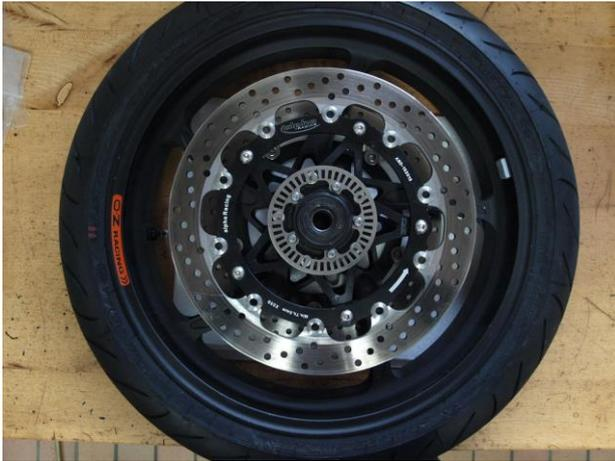
17. Neuen Reifen (120/70 ZR 17 58W) auf der Vorderradfelge montieren (Laufrichtung beachten) und anschließend Vorderrad wuchten.
