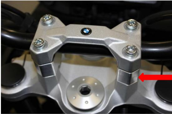
Lenker Demontage: Lösen der Verschraubung des Lenkers
