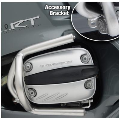
Diese Sturzbügel bieten einen optimalen Schutz für Sie und Ihr Motorrad, weil sie direkt an der stabilen Motorhalterung befestigt werden. Sie bieten somit eine optimale Kräfteverteilung. Diese Sturzbügel sind aus nicht rostendem Edelstahl gefertigt und müssen bei Arbeiten am Motor nicht extra abgebaut werden. Wird auch als Motorschutzbügel / Motorbügel / Motorschutz bezeichnet.
