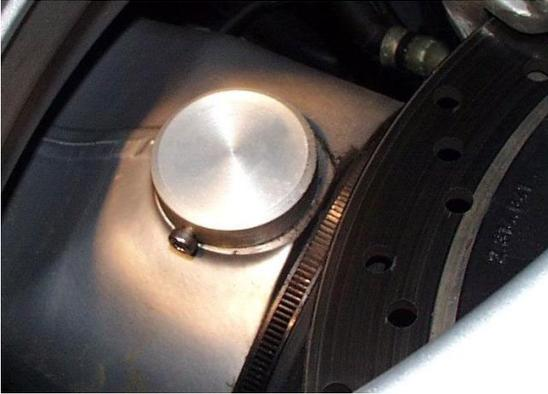
Kardanschraubenabdeckung für die Innenseite (Innenseite, Bremsscheibe).
