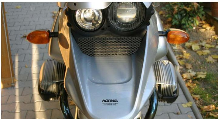
Sehr guten Schutz für den Ölkühler und zugleich einen optischen Leckerbissen bietet Ihnen dieses Kühlergitter. Es besteht aus einem sehr stabilen Rahmen, der kein Flattern zulässt und garantiert Stabilität durch die aufwändige Verbindungstechnik (Hochdruck-Klebertechnologie) zwischen Gitter und Rahmen. Außerdem werden Schmutz, Insekten etc. vom Kühler ferngehalten. Mit Montagematerial (Kratzschutz, Halter etc.).
