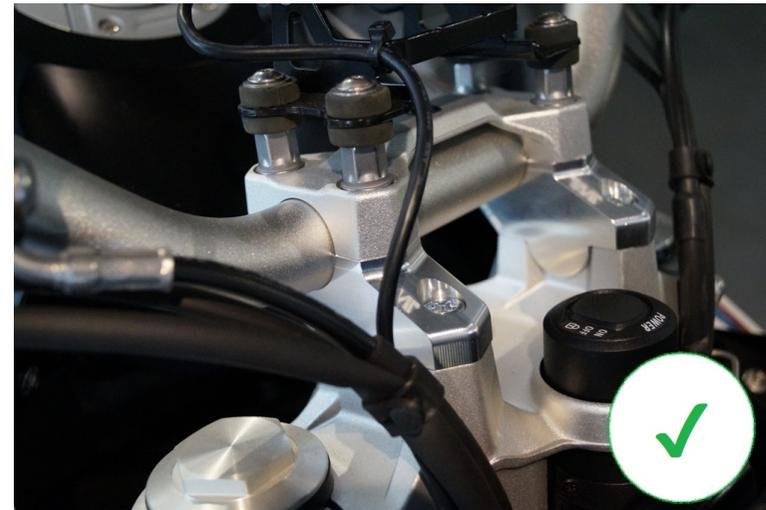
**Hinweis:** Bitte achten Sie nach erfolgter Montage darauf, dass auch bei voll eingeschlagenem Lenker der Brems- und Kupplungsschlauch, Züge und Kabel weder spannen noch scheuern!
